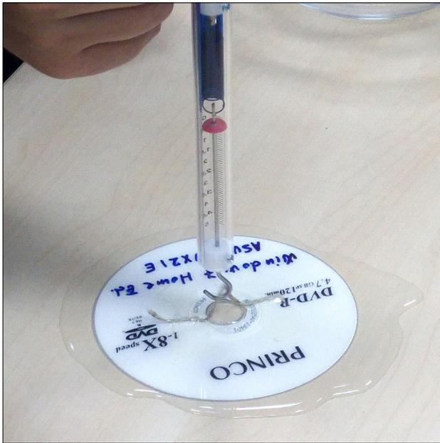
Figura 28. Le forze di adesione vengono misurate.
