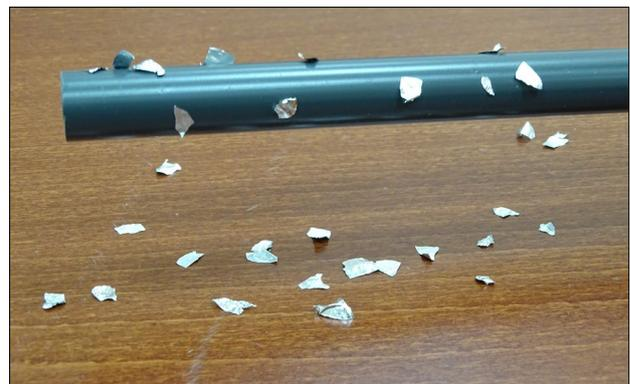
**Figura 38.** Barra in PVC elettrizzata che attrae pezzettini di alluminio.
