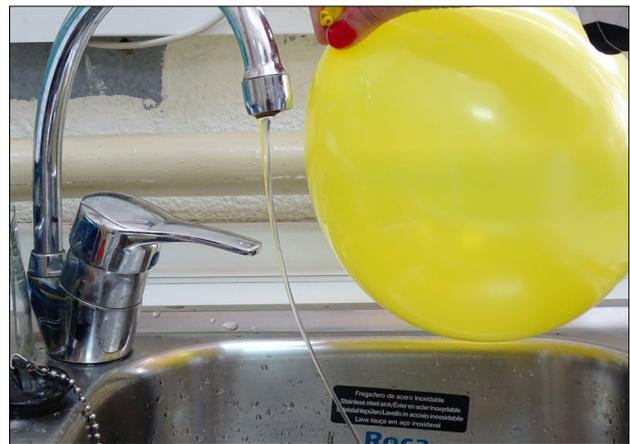
Figura 35. Un palloncino elettricamente carico attrae il flusso d'acqua debole.
