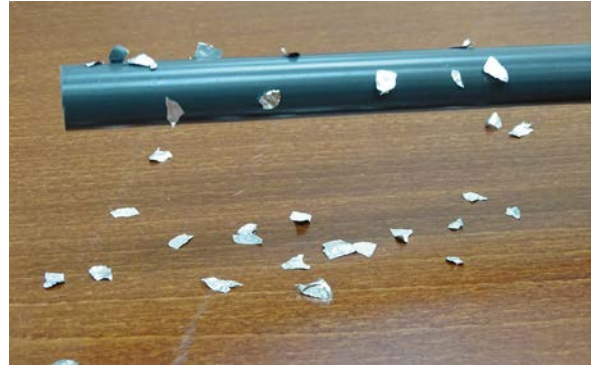
Joonis 38. Elektrifitseeritud PVC-pulk alumiiniumitükke ligi tõmbamas.
