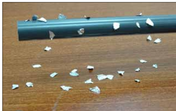
Fot. 38. Naelektryzowany pręt PCV przyciąga kawałki aluminium.
