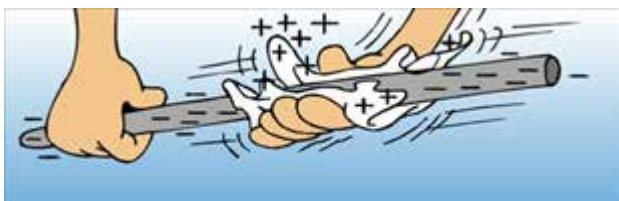
Fot. 46. Elektryzowanie izolatora.
