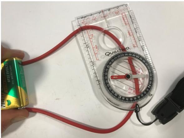
Comprueban que la aguja siempre se orienta perpendicularmente al cable, por lo que es influenciada por el paso de la corriente eléctrica a través del cable.
