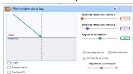
Aplicación que permite observar el fenómeno de la refracción cambiando distintos parámetros.
