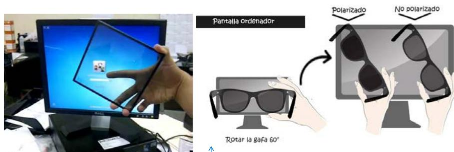
Las pantallas LCD o de cristal líquido de los televisores, móviles, ordenadores, etc. llevan en su interior un filtro polarizador, de forma que siempre emiten luz polarizada. Si colocamos delante de ellos otro filtro polarizador y lo giramos, podemos observar cómo cambia la intensidad de la luz.
