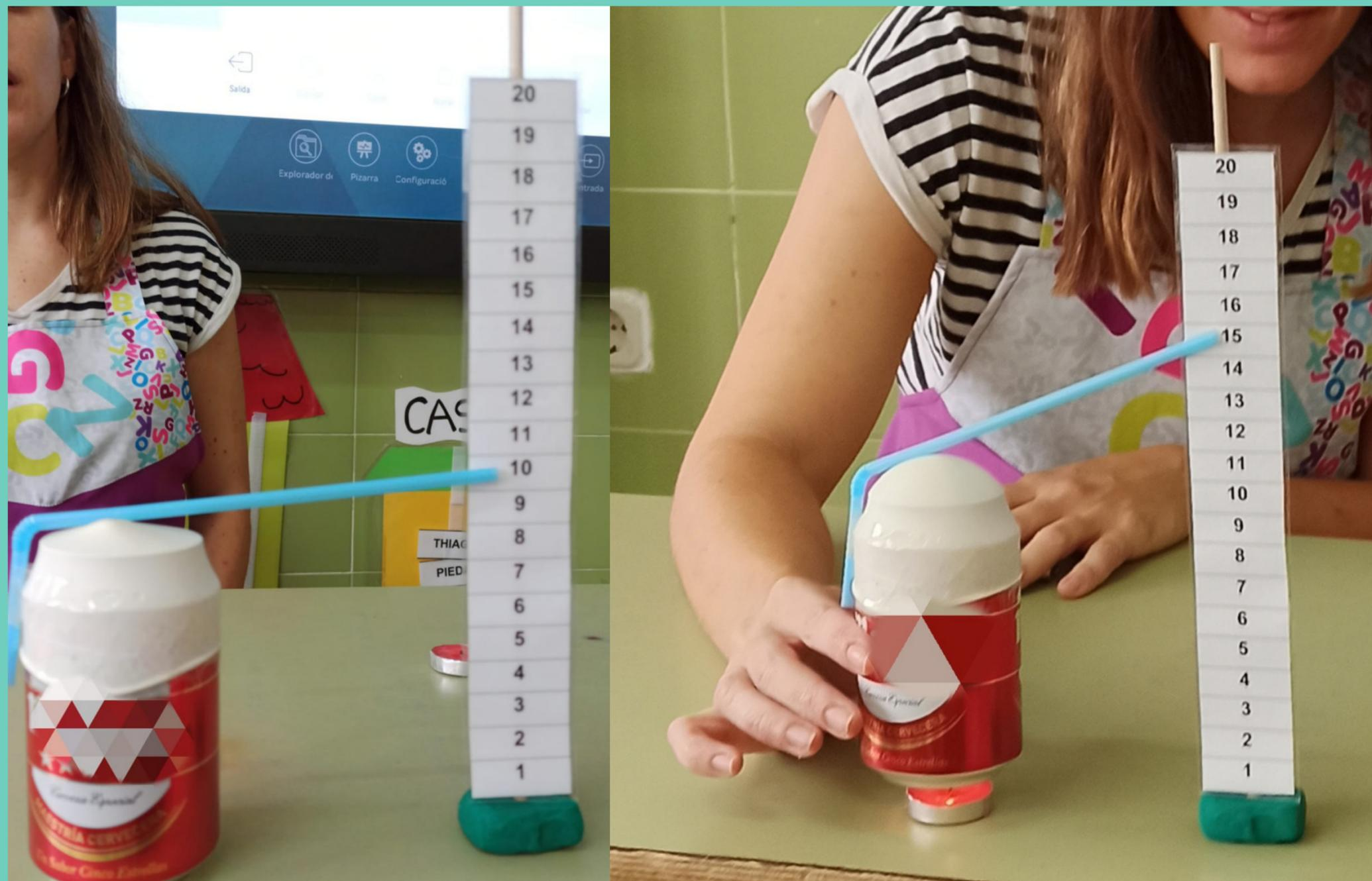
Colocamos un globo en la parte de arriba de una lata con aire. Pegamos una pajita. Aplicamos calor con una vela y comprobamos que la pajita sube en el marcador.
