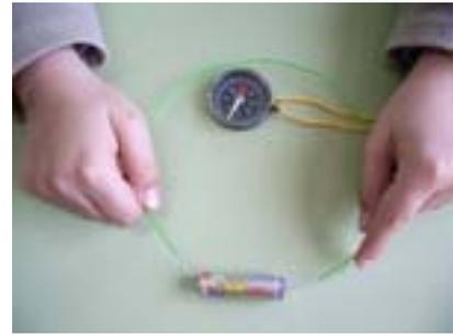
A continuación los alumnos-as volverán al aula para llevar a cabo la siguiente actividad, consistente en demostrar que la electricidad genera un campo magnético. Para ello se da a los alumnos-as una pila, un cable con los extremos pelados y una brújula.
